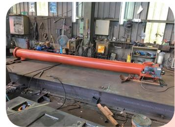
電爐加砂系統螺旋輸送機
